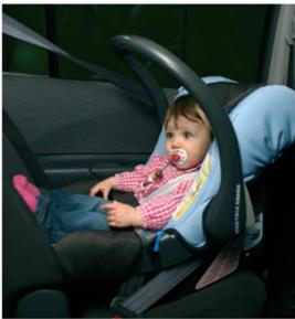
Группа 0+ (менее 13 кг): ребенок путешествует в автолюльке, оснащенной трехточечным ремнем безопасности, которую устанавливают против хода движения автомобиля (спиной вперед). Автолюлька фиксируется штатными ремнями безопасности или с помощью якорной опоры крепления системы Isofix, позволяющей быстро установить автолюльку при каждом передвижении.
