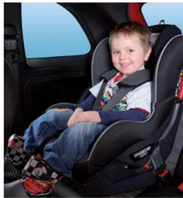
Группа 1 (9-18 кг): ребенок пристегнут в автокресле пятиточечным ремнем безопасности, встроенным в заднее сиденье, лицом или спиной по ходу движения в зависимости от выбранной модели.
